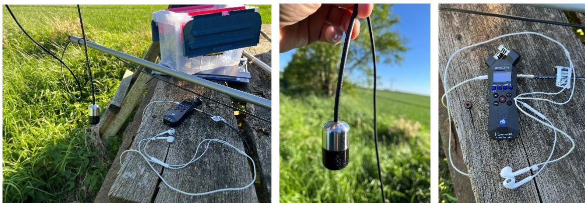
Abb. 2.14 Einsatz eines Hydrophons, das an einer Teleskopstange befestigt wurde, zum Nachweis der Knoblauchkröte - Zusatzmethode A4. Links: Teleskopstange mit Hydrophon sowie Aufnahmegerät mit Kopfhörer, Mitte: Detailaufnahme des Hydrophons, Model H2d, rechts: Detailaufnahme des Aufnahmegerätes, Typ H1essential mit Kopfhörer (Foto: B. Förster).
